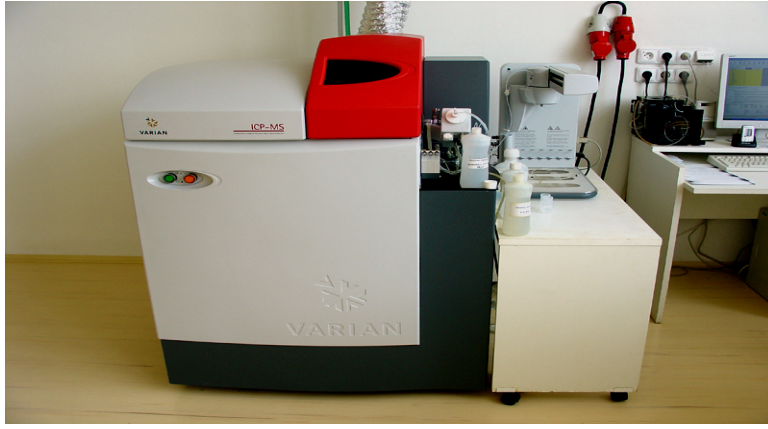
شكل 6.2: يوضح مطياف الكتلية البلازمية المتولدة بالحث
