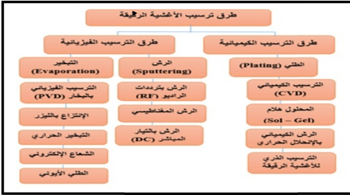
الشكل (II-1): مخطط توضيحي لتقنيات ترسيب الأغشية الرقيقة [1]
