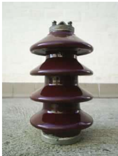
Figure II.6 Isolateurs à long fût
