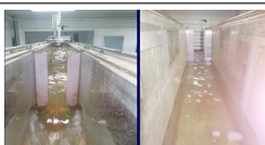
Photographie 2: déversoir rectangulaire avec contraction latérale permettant de mesurer des débits pompés.
