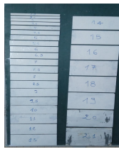
Photographie 5: La série de seuils minces ayant servi au contrôle du ressaut.
