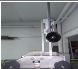
Photographie 3: Mesure de la profondeur d'eau par pointe limnimètre.
