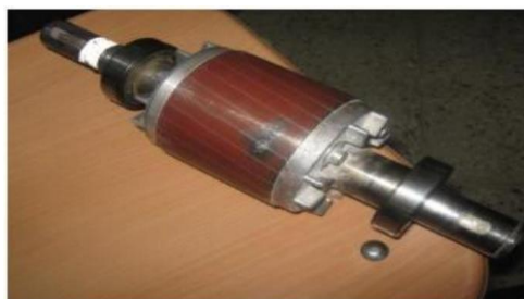
Fig.I.10 : Défaut dû à une barre rompue dans le rotor.
