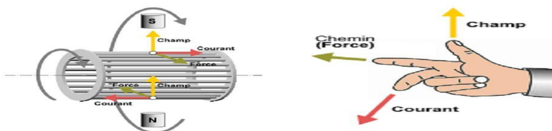
Fig.I.6 : Principe de fonctionnement simplifié d'un moteur asynchrone [27].
