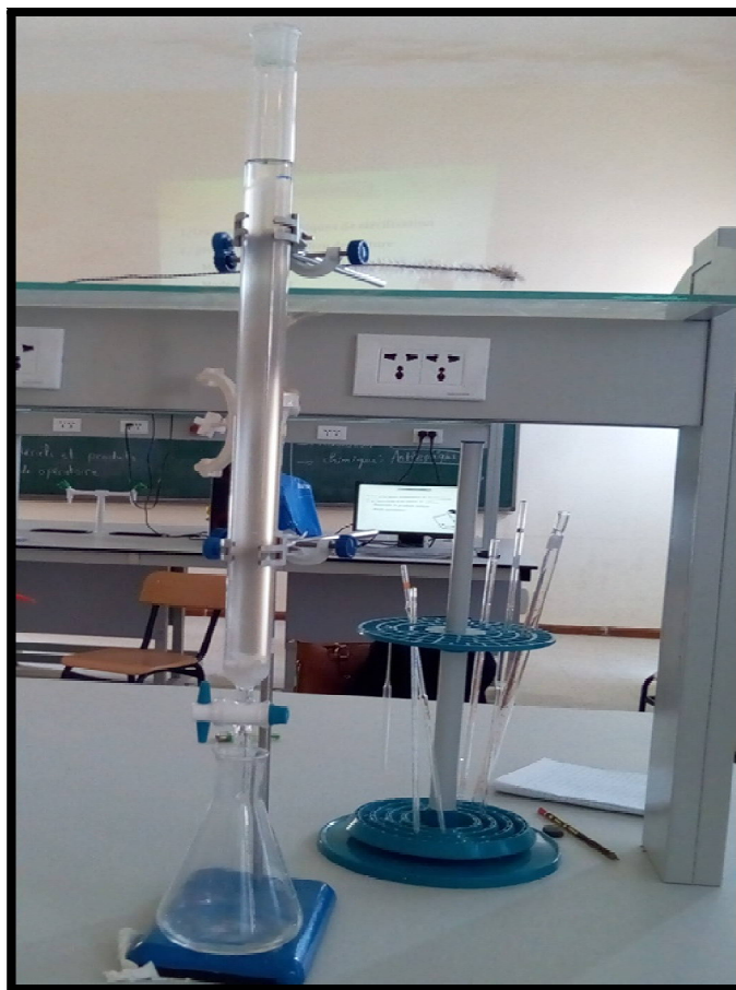
Figure 10: Etape de stabilisation de phase stationnaire (Ba et Settour,2018).
