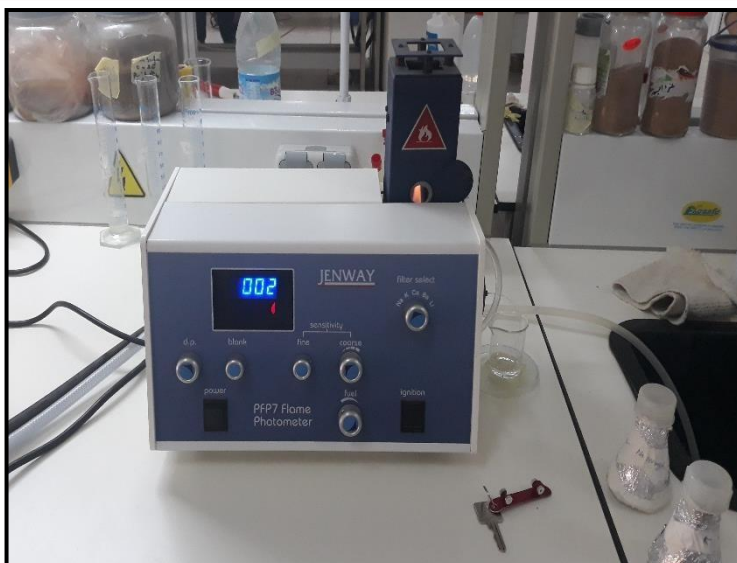
Photo.III.04: Photomètre de flamme industriel PFP7 – Jenway et mode d'emploi (2021).
