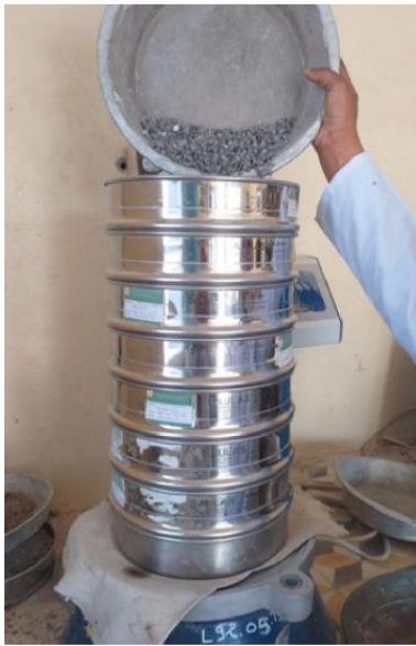
صورة (9-III) تجربة التحليل الحبيبي للحصى
