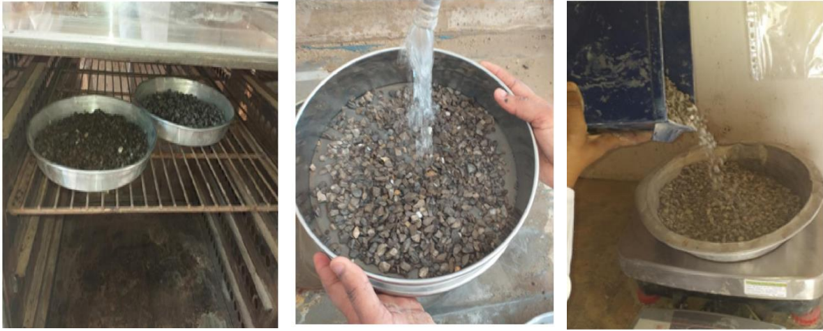
صورة (8-III) تجربة إمتصاص الماء للحصى
