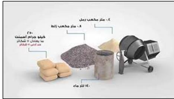
صورة (III-1) مكونات الخلطة الخرسانية
