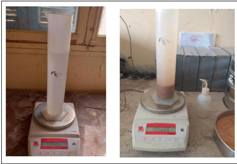
صورة (6-III) تجربة الكتلة الحجمية المطلقة للرمل
