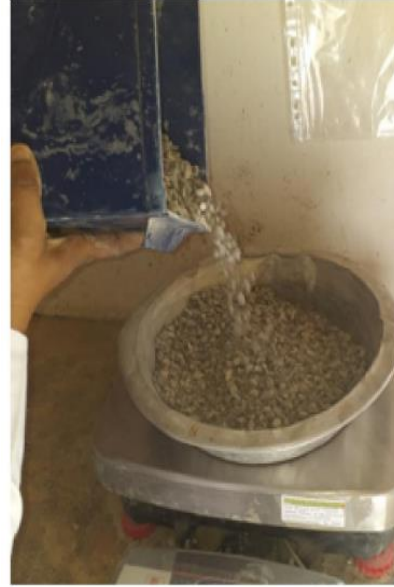
صورة (9-III) تجربة التحليل الحبيبي للحصى
