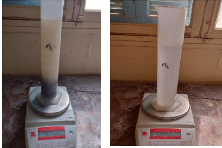
صورة (7-III) تجربة الكتلة الحجمية المطلقة للحصى
