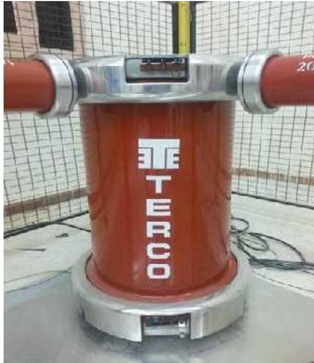
Figure III.2: Transformateur à haute tension utilisé pour l'essai de claquage de l'air.
