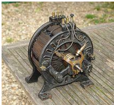
Fig. I 3 Ancien moteur à courant alternatif bobiné en anneau au stator, [1]
