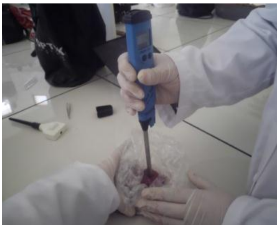
Figure 25 : Mesure de conductivité électrique (Photo personnelle ., 2013).
