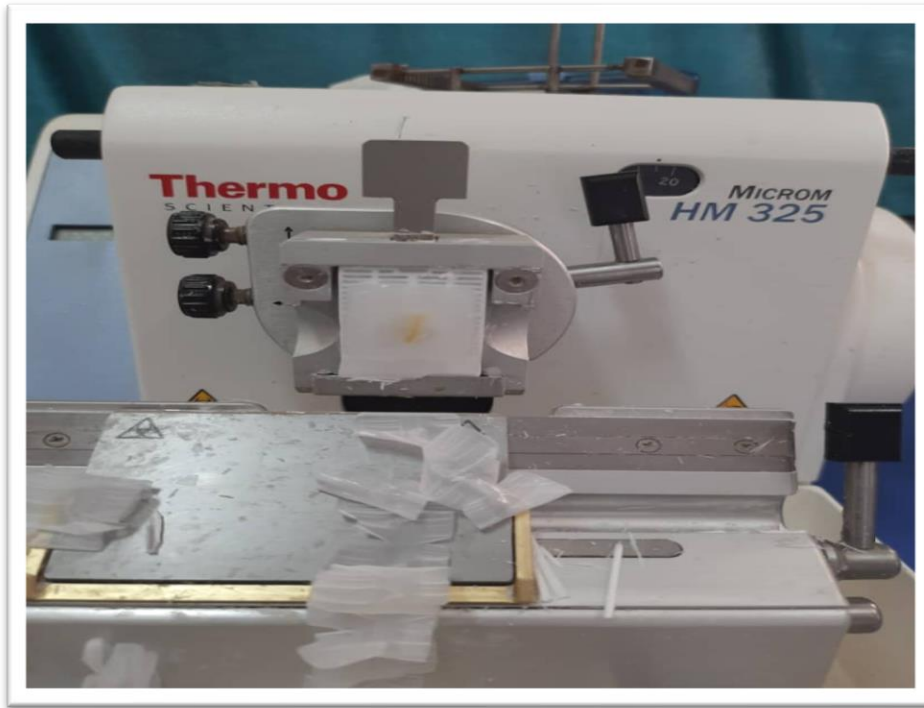
الشكل II.10: صورة توضح جهاز قطع الشرائح المجهرية لعينة النسيج.
