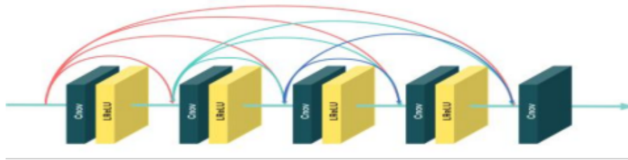
FIGURE 2.4 – Diagramme schématisique du modèle de bloc dense.
