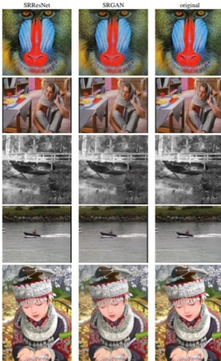
FIGURE 1.22 – Résultats pour cinq échantillons aléatoires de BSD100 en utilisant SRResNet et SRGAN.(4× mise à l'échelle).[9]
