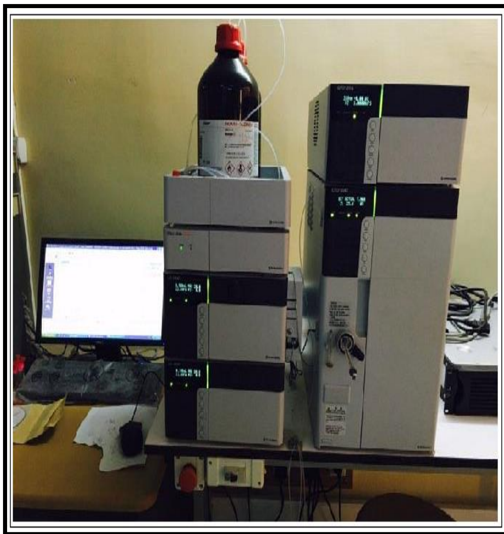
صورة لجهاز الكروماتوغرافيا العالية الجودة HPLC
