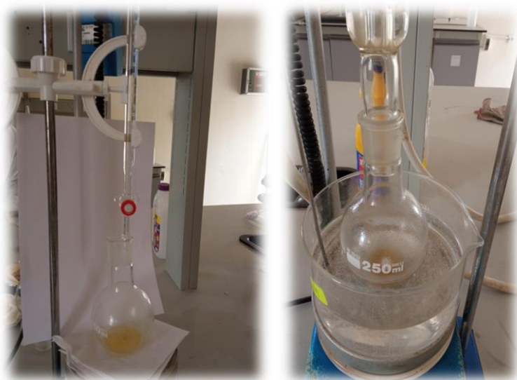
الشكل (7-IV): عملية المعايرة لتحديد قرينة التصبن [01]
