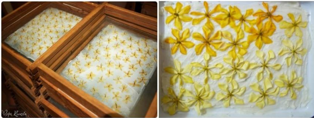
الشكل (9-II): صورة فوتوغرافية لمبدأ الاستخلاص بالشحوم. [36]
