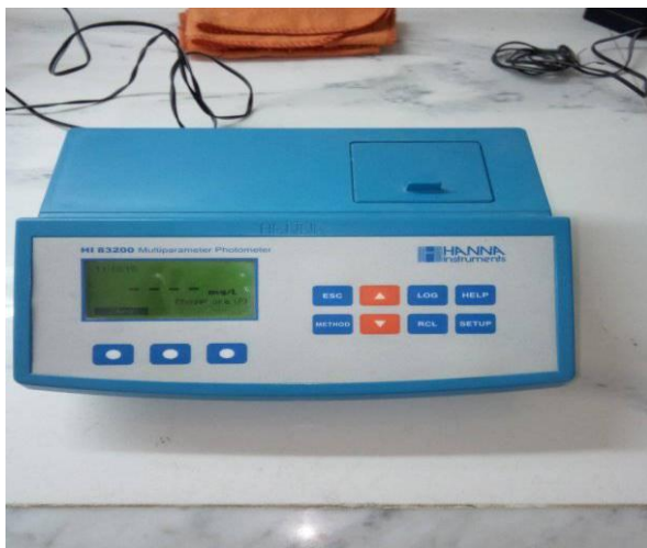
Figure 19 : Spectrophotomètre utilisé pour le dosage des nitrates et phosphates.
