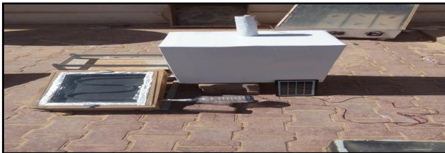
الشكل (III.5) : التركيب التجريبي للمجفف الشمسي الغير مباشر.
