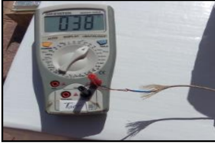
الشكل (أ.1): صورة جهاز رقمي لقياس درجة الحرارة موصول بمزدوج الحراري (Thermocouples).
