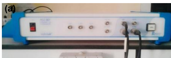
الشكل (8.II) (a) جهاز Galvanostat VOLTALAB - Potentiostat ZPG301 (مختبر VTRS)
