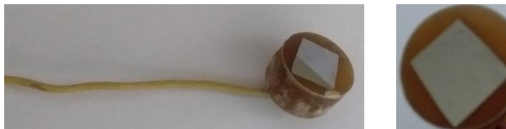
الشكل (1.II): a عينة التصوير بالمجهر الضوئي b- عينة الدراسة الالكتروكيميائية
