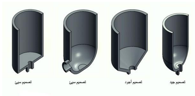
الشكل ( 20.I): يوضح الأسطح المعرضة للتآكل [10]
