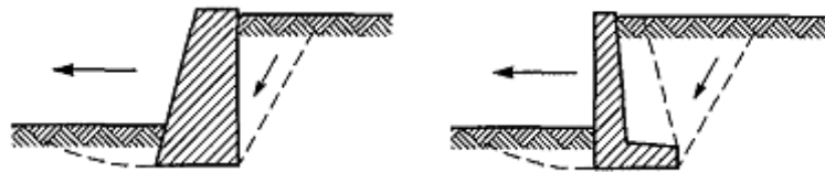
Figure 2.10 : Rupture par glissement sur la base du mur
