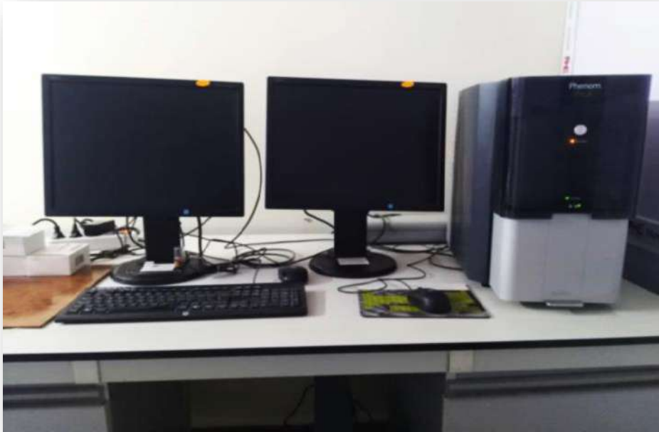
شكل (II.13): جهاز المجهر الإلكتروني الماسح (SEM) المزود بنظام EDX.
