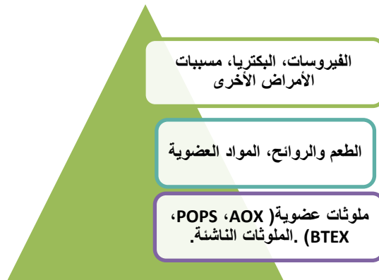
الشكل (2): مخطط يوضح فعالية تقنية (AOP) في إزالة الملوثات التي تستهدفها.
