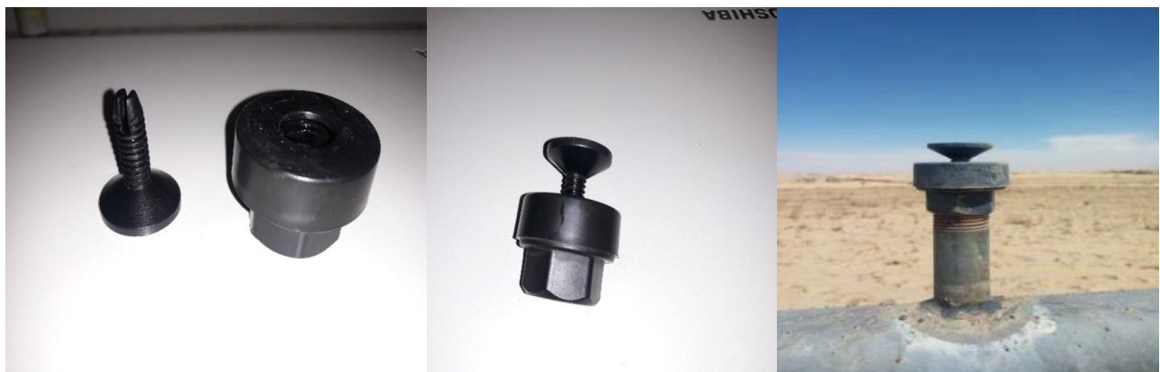
Figure I. 8 Présentation de la buse de pulvérisation
