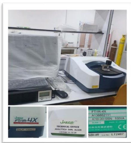
الشكل 5 : صورة جهاز FTIR المستعمل في التجربة.
