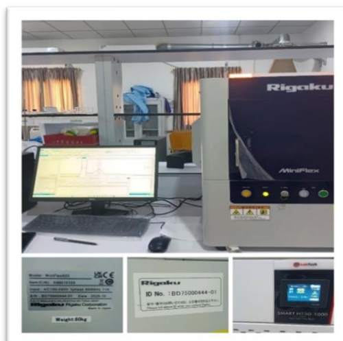
الشكل 2 : جهاز حيود الأشعة السينية DRX.
