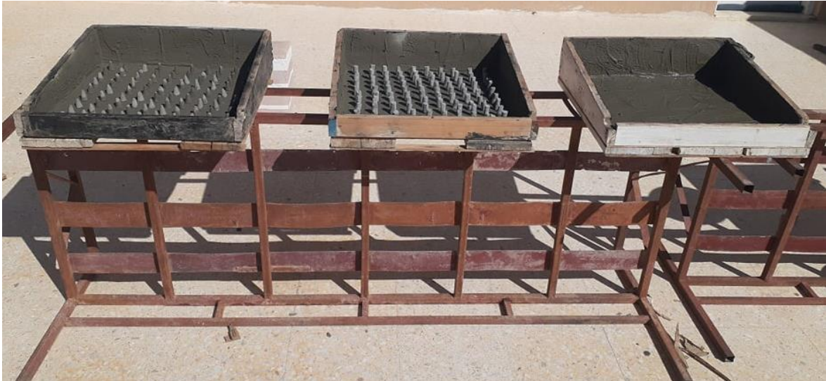
الشكل (10-3): صورة للمقطرات الشمسية (الشاهد- المحسن بالزعانف الأسطوانية- المحسن بالزعانف المخروطية)
