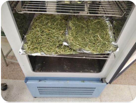
Photo (10) : placement d'un échantillon dans le four pour le sécher
