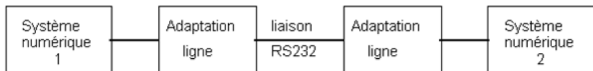
Figure II.12 : Schéma fonctionnel d'une liaison série asynchrone de la norme RS232
