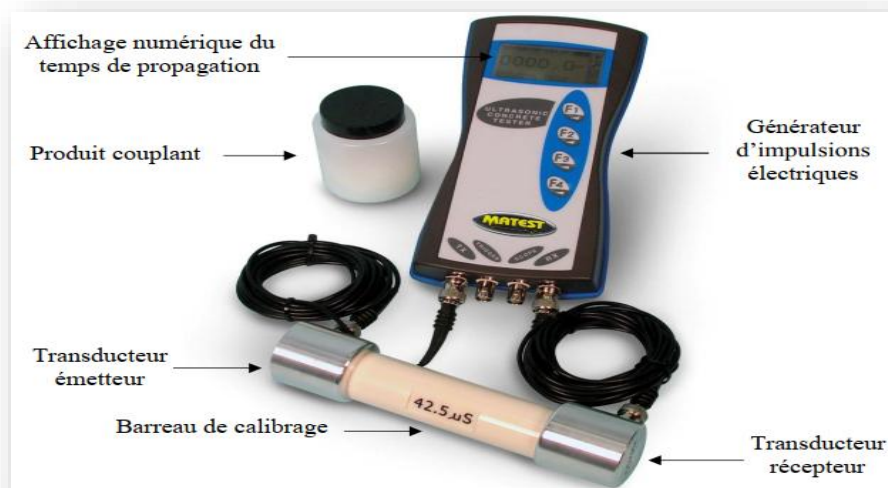
Figure I.11 : Appareil d'auscultation sonore et ses accessoires [33]
