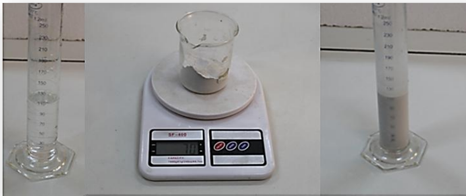
Figure II.18 : Exemple mesure la masse volumique absolue [1]
