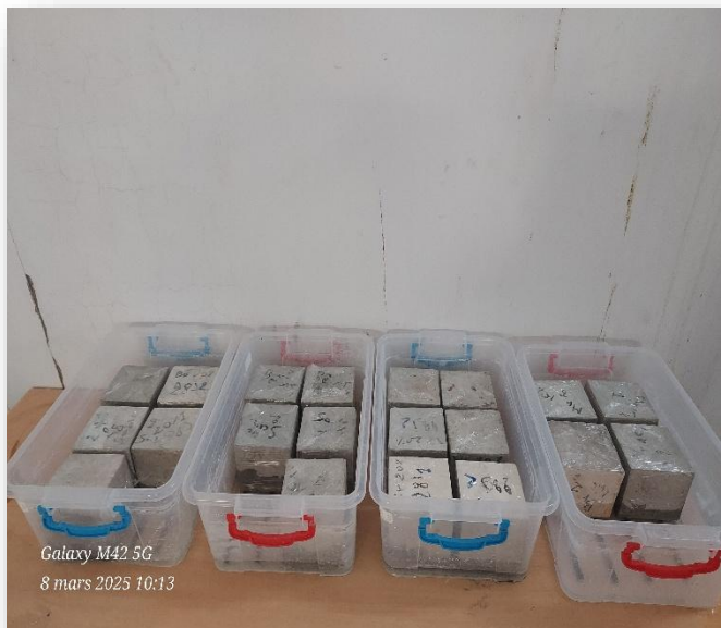
Figure IV.13: Echantillons pour l'essai de l'absorption d'eau par capillarité
