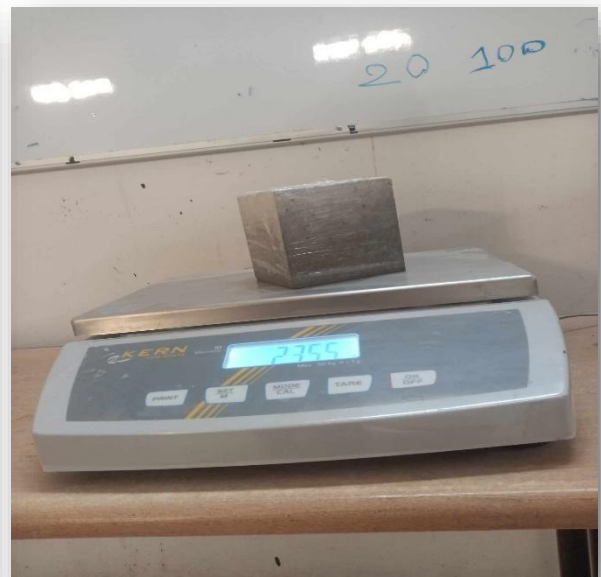
Figure IV.13: Echantillons pour l'essai de l'absorption d'eau par capillarité
