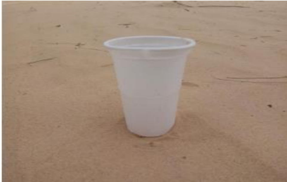
Figure III.3. Gobelets en plastique utilisée dans le pluviomètre.
