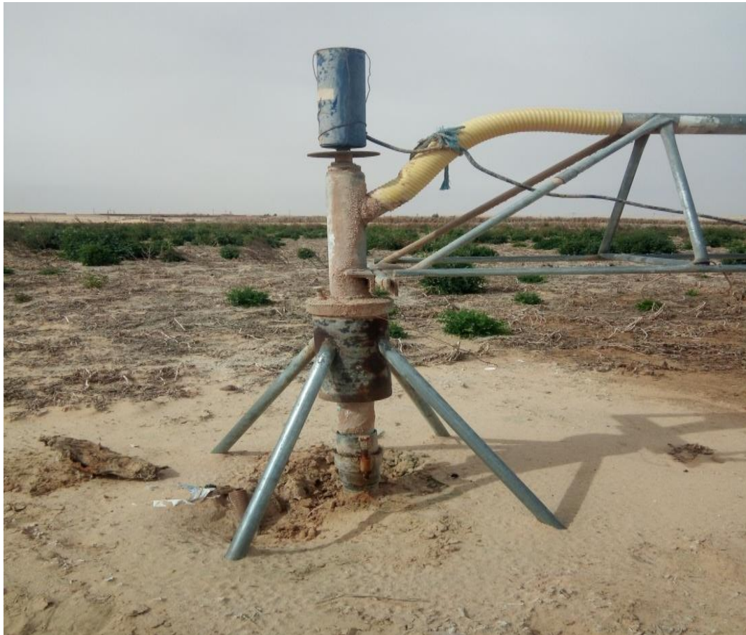
Figure I. 2. Unité centrale sur pivot d'irrigation traditionnel
