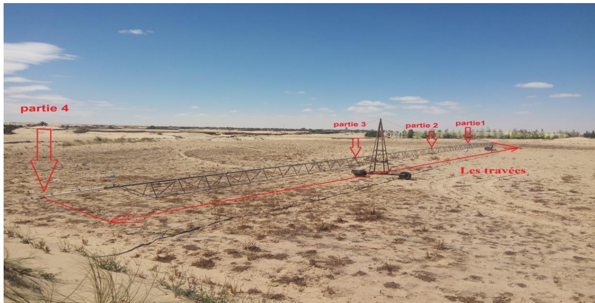
Figure I. 3. La travée de pivot d'irrigation traditionnel
