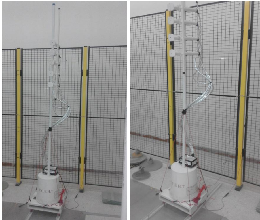
Figure III.6 : Appareil du mesure du champ électrique (C.C.E.H.T)
