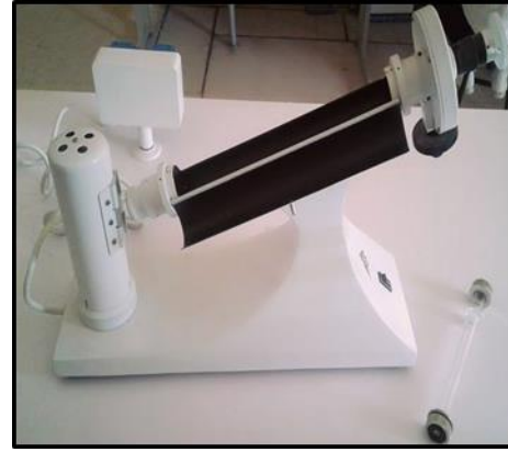
الشكل (7.IV): يوضح جهاز Polarimètre
