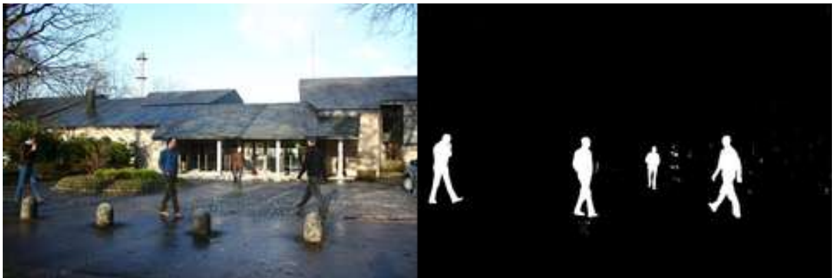
Figure II-5 présentation de La méthode de soustraction de fond.
