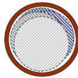
(b) Excentricité dynamique (Plusieurs positions du rotor au cours de la rotation)
