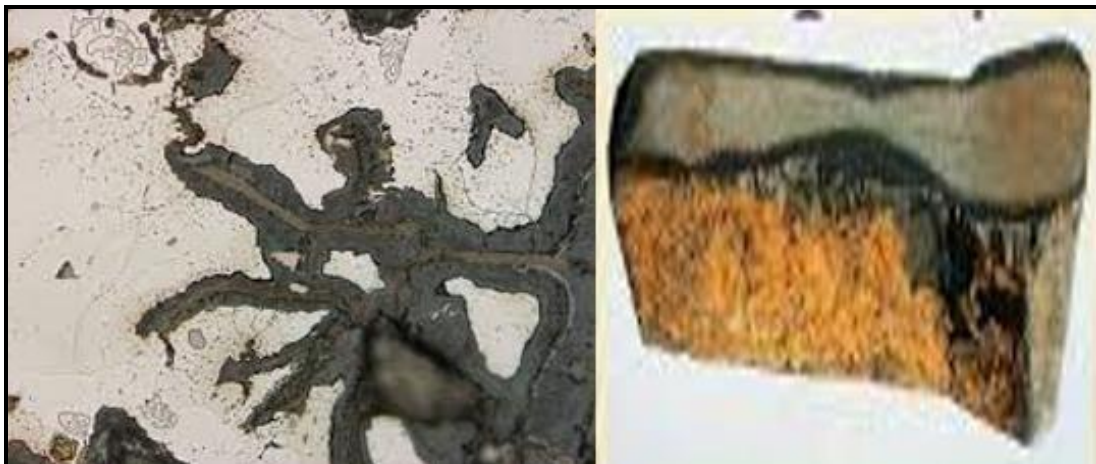
Figure III.5: Exemples de corrosion sélective.
