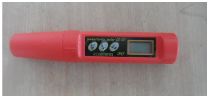
Figure III-6 : conductimètre pour mesurer les différentes conductivités de pollution utilisées aux essais
