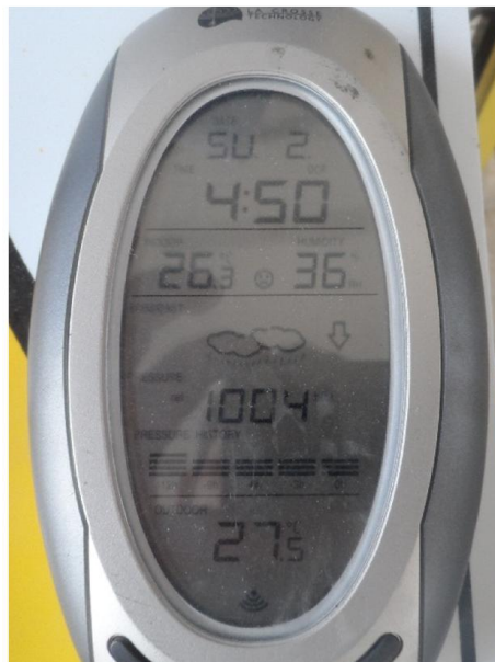
Figure III-14 : instrument de mesure pour les conditions atmosphériques (Humidité, température et pression)
