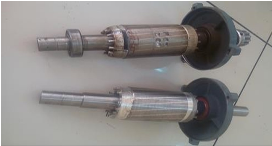
Figure I-11 Cassures de barres et de portions d'anneaux (laboratoire de la faculté de technologie-université d' El Oued).
