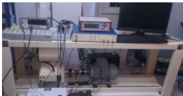
Figure III.2. Image du banc d'essai dédié au diagnostic (Dspace1104).
