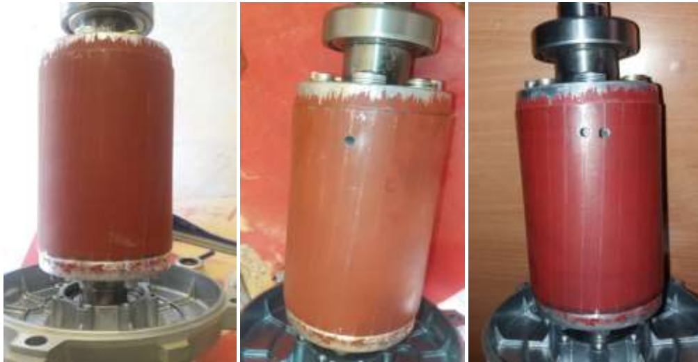
Figure III.4. Photographie des rotors de la MAS de 3 kW pour un état sain (à gauche), une barre cassée (au centre), deux barres cassées (à droite).
