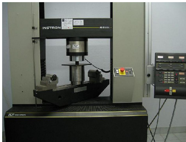
Figure (II.8): Processus de compression d'un cylindre en matériau composite réalise sur une machine d'essai universelle.
