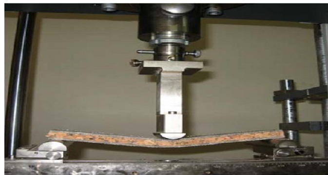
Figure (II.7): Test de flexion sur dispositif de flexion.
