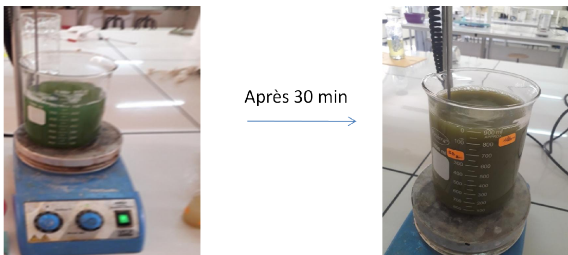
Figure (II.11): La phytoréduction de \text{CuSO}_4 en nanoparticules d'oxyde de cuivre.
