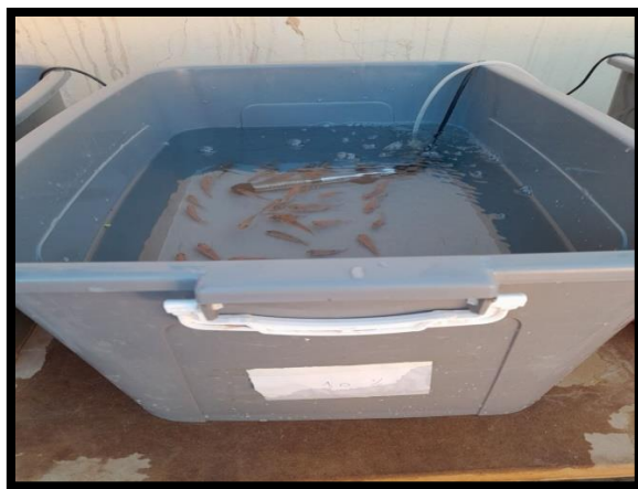
Figure 30 : Dispositif de maintien de l'homogénéité thermique et gazeuse du milieu.
