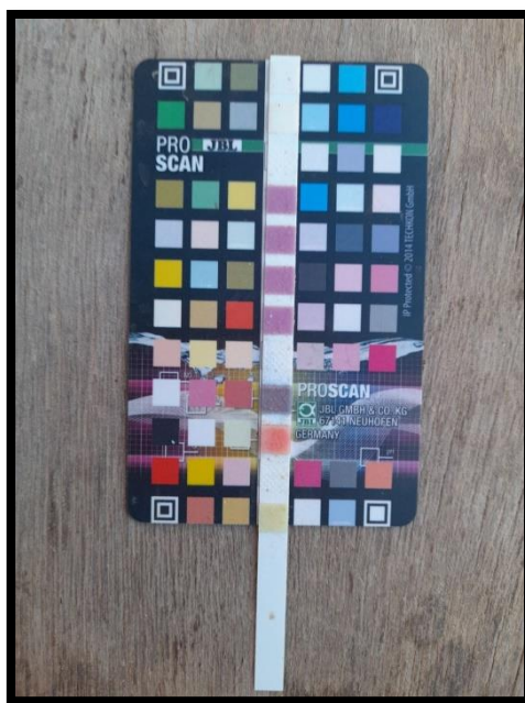
Figure 34 : Lecture automatisée de la bandelette réactive par smartphone via l'application JBL ProScan.
