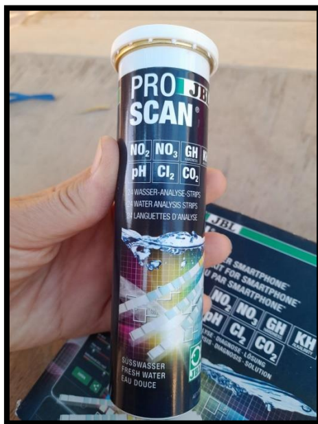
Figure 32 : Dispositif JBL ProScan utilisé pour le contrôle instantané de la qualité de l'eau.
