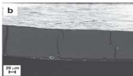
الشكل (3-IV): ميكروغرافات SEM للأشرطة المركبة
