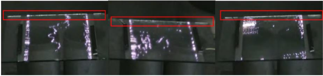
Figure II.8. Bruit présent sur les images, causé par la réflexion de la lumière sur le bord supérieur de l'isolateur plan
