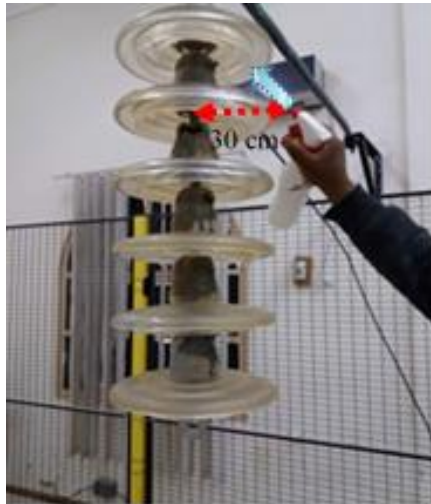
Figure II.9. Méthode de pulvérisation
