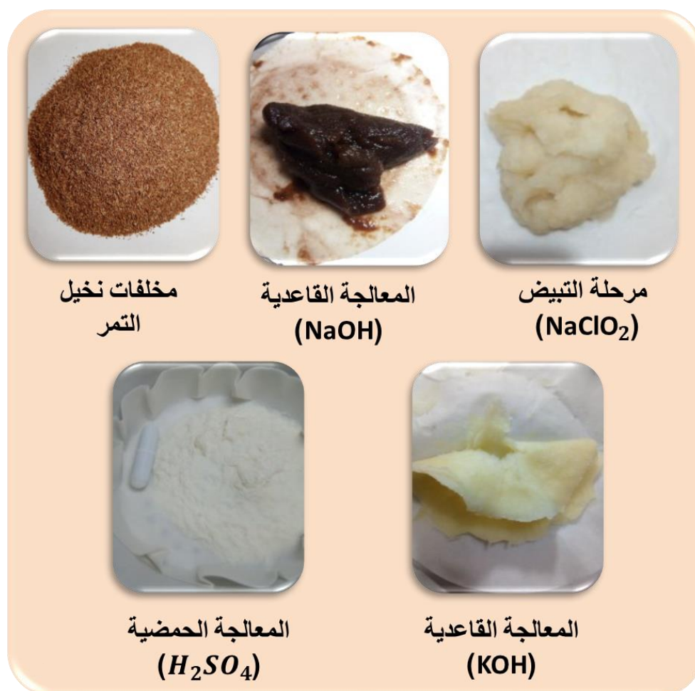
الشكل 31: صور فوتوغرافية توضح تأثير المعالجات الكيميائية على العينات المدروسة.
