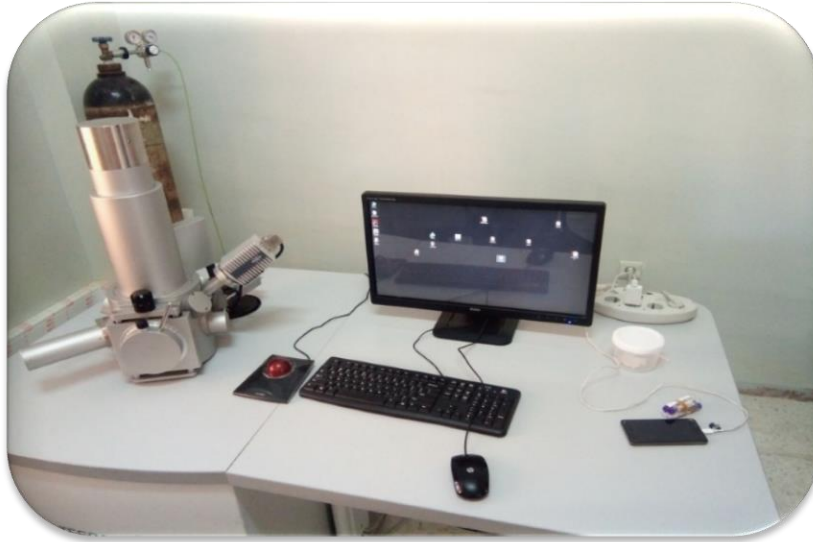
الشكل 27: المجهر الإلكتروني الماسح (SEM).
