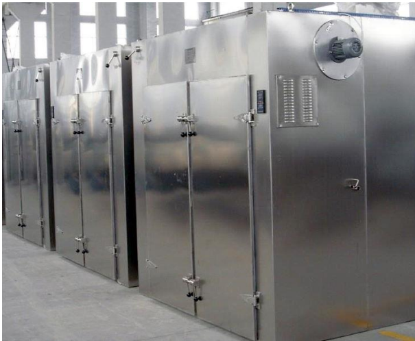
figure 15 : séchage à l'air chaud
