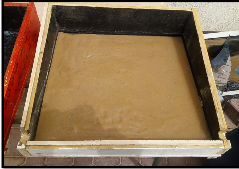
الشكل (3-18): مقطر شمسي مسطح يحتوي التراب.
