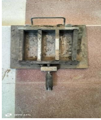
الصورة 8.111: القالب المستخدم في الصب
