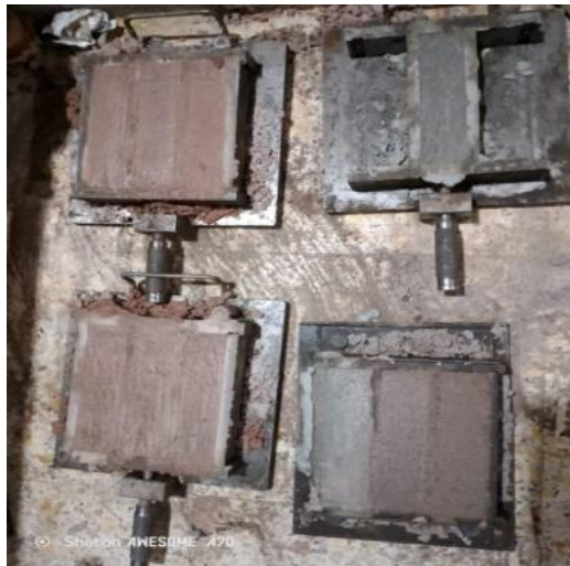
الصورة 9.111: العينات اثناء الصب
