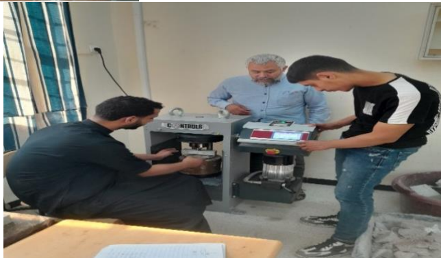
الصورة 1.14: أثناء التحطيم بواسطة الانحناء في مخبر جامعة الوادي
