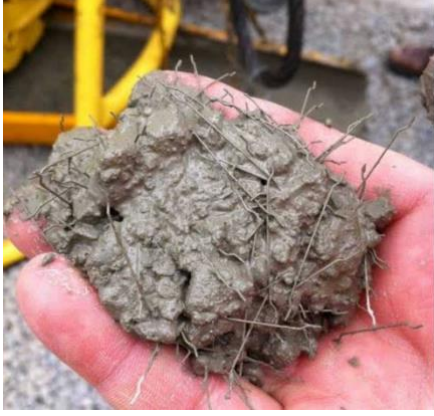
الصورة 4: خرسانة المسلحة بالألياف
