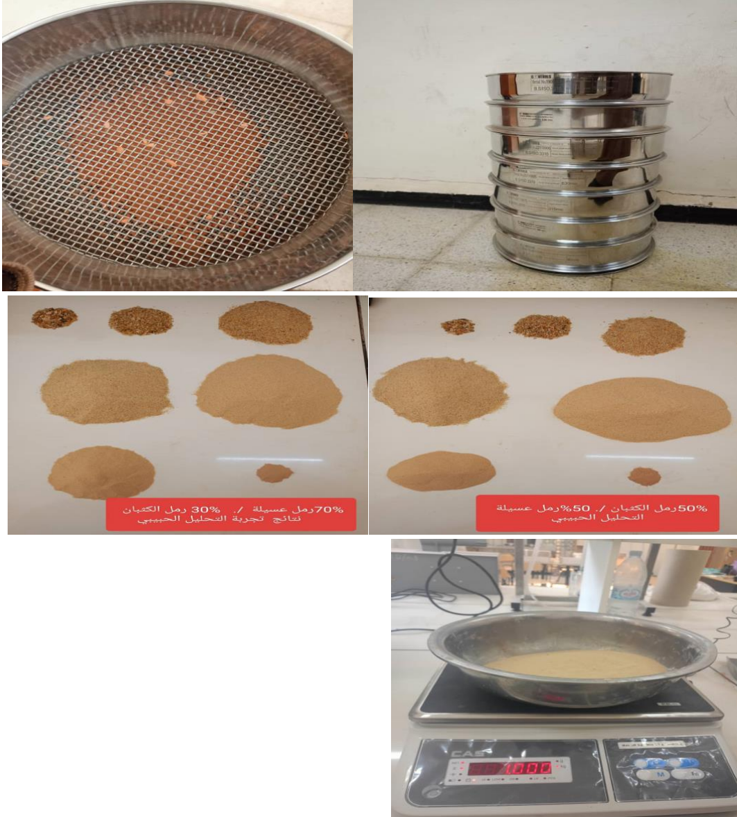
الصورة 5.111: اثناء قيام بتجربة الغربلة في مخبر جامعة الوادي
