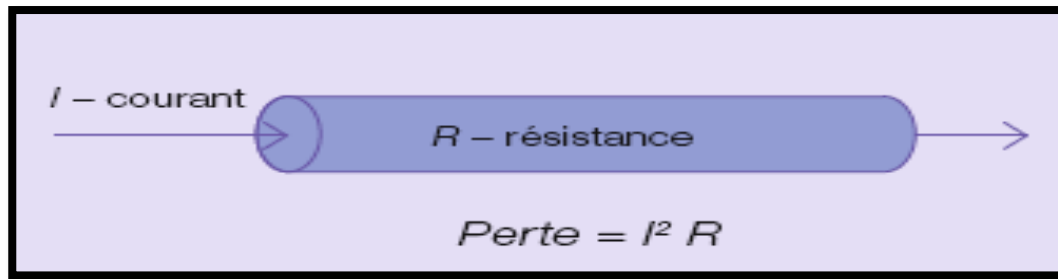
Figure I.3 : Pertes par effet Joule RI^2
