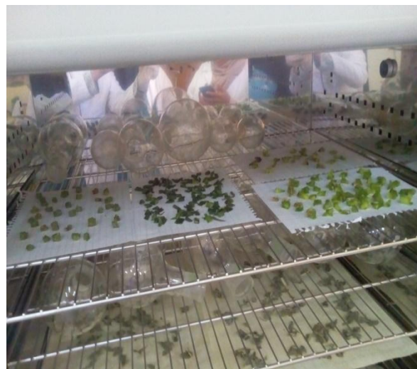
Figure(III.5): Séchage Les deux échantillons d'une étuve.
