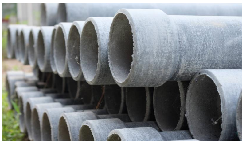
Figure–11: Conduites en amiante – ciment.
