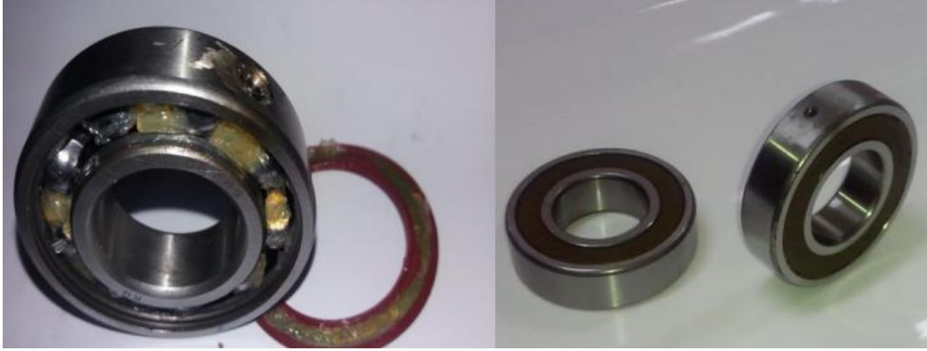
Figure (III.1) Photos d'un roulement défectueux dans la BE.
