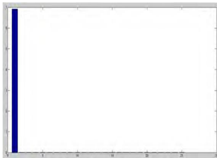
Figure III.23 : Spectre d'harmonique du courant de la charge I_{ch} pour ( f_c = f_r = 918.88\text{Hz} ) et \text{Thd} = 0.0702\% .
