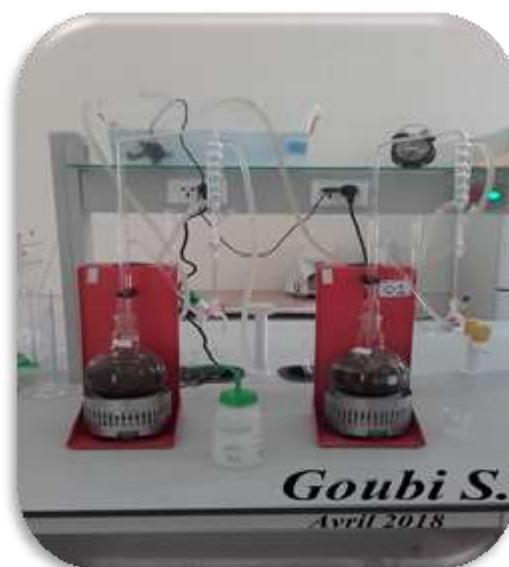
Fig.18: Montage d'hydrodistillateur type Clevenger.
